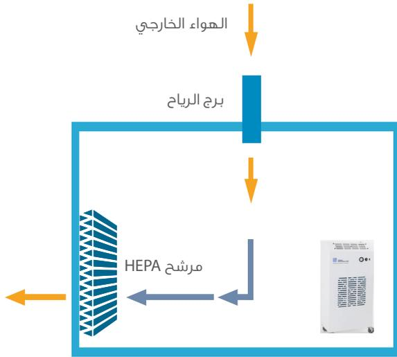
HEPA هو نوع من مرشحات الهواء الميكانيكية ذات الطيات. وهو اختصار لعبارة: «رشح جسيمات الهواء عالي الكفاءة». نظرياً، يمكن لهذا النوع من مرشحات الهواء إزالة ٩٩,٩٧٪ على الأقل من الأتربة وغبار الطلع والعفن والبكتيريا وأي جسيمات محمولة عن طريق الهواء بحجم (٣,٠ ميكرون متر).
